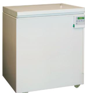
Суховоздушный криостат **ТСВ-02** предназначен для хранения нефтяных проб. Может использоваться для термостатирования других объектов в заданном диапазоне температур.
