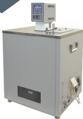
Специализированный криостат **КРИО-VT-13** предназначен для поддержания заданной температуры жидкого теплоносителя, циркулирующего во внутренней ванне криостата и в подключенных внешних потребителях. В качестве внешних потребителей к криостату могут быть подключены термостатирующие контуры лабораторных химических реакторов, измерительных приборов и другого оборудования. Криостат КРИО-VT-13 предназначен для непрерывной работы.
