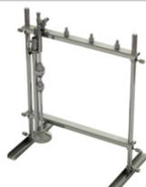
Штатив для вискозиметров позволяет удобно разместить до шести подготовленных к измерению вискозиметров любого вида
