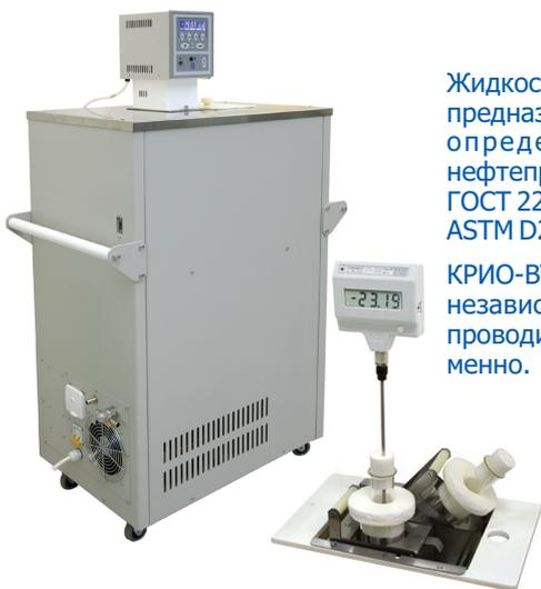
Жидкостные криостаты **КРИО-VT-05-01** и **КРИО-VT-05-04** предназначены для поддержания заданной температуры при определении низкотемпературных характеристик нефтепродуктов в соответствии с ГОСТ 20287, ГОСТ 5066, ГОСТ 22254, ГОСТ 18995.5, ASTM D97 (ISO 3016), ASTM D7346, ASTM D2386 (ISO 3013), ASTM D2500 и ASTM D6371.
