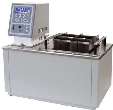
Жидкостные термостат **BT20-3** и криостат **КРИО-ВТ-04** предназначены для поддержания заданной температуры при проведении испытаний асфальтобетона или битумов нефтяных в соответствии с ГОСТ 9128, ГОСТ 12801 и ГОСТ 11501.
