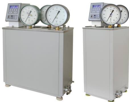
Жидкостные термостаты **BT-P-01** и **BT-P-03** предназначены для поддержания заданной температуры при определении давления насыщенных паров нефтепродуктов с помощью бомб Рейда в соответствии с ГОСТ 1756, ASTM D323 и ASTM D1267.
