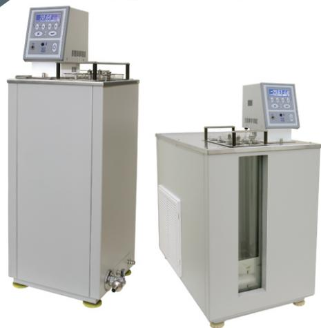
Жидкостные термостаты и криостаты модельного ряда **BT-ро** предназначены для поддержания заданной температуры при проведении измерений плотности нефтепродуктов в соответствии с ГОСТ 3900, ГОСТ Р51069, ASTM D1298, IP 160 и ISO 3675. Все термостаты и криостаты этого модельного ряда снабжены приспособлением для установки шести стеклянных или металлических цилиндров для ареометров.
