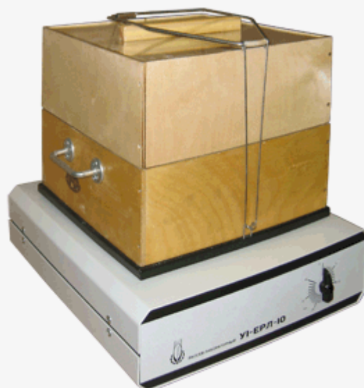
рассев лабораторный У1-ЕРЛ-10-6 с комплектом для определения зараженности муки
