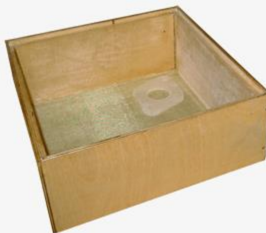
сито с очистителем из комплекта для определения зараженности муки
