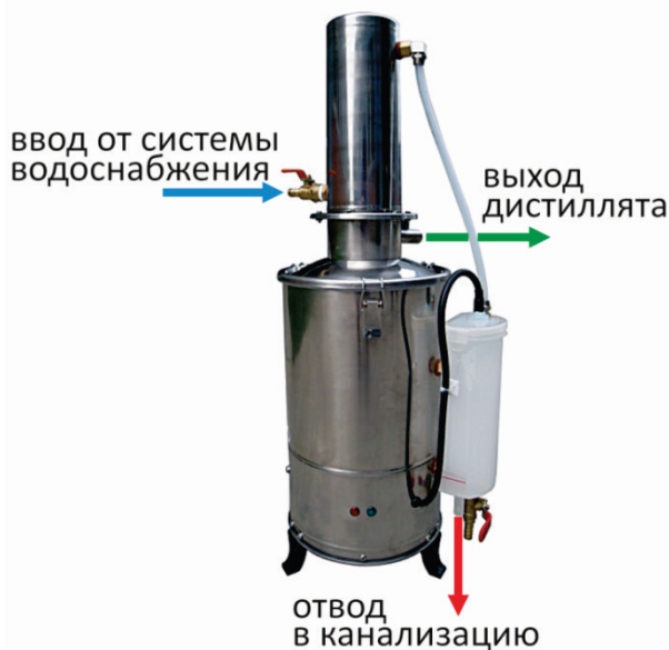
Рисунок 3 – Схема подключения дистиллятора
